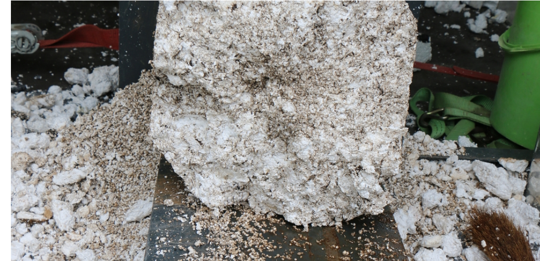
Theoretisch kann das Polystyrol auf 5 % seines Ursprungsvolumens zusammengepresst werden. (Quelle: DDH)
